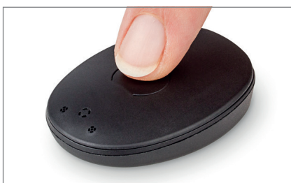
Obr. 2 Aktivace/deaktivace audio procesoru
