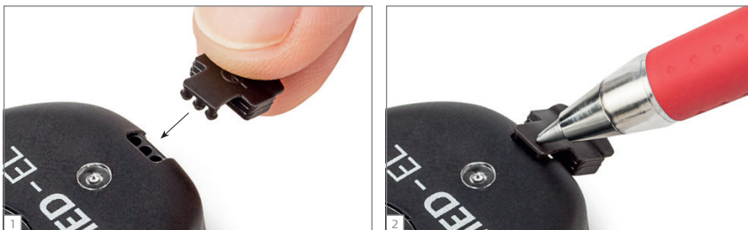
Obr. 15 Opětovné připojení těsnění konektoru
