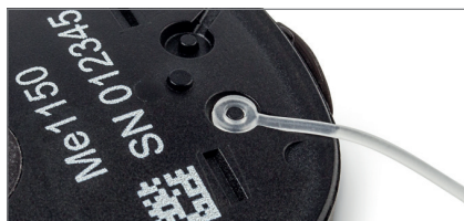
Obr. 13 Zajištění připojovací spony na pouzdru audio procesoru
